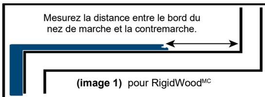
6. Emboutissez le morceau de plancher dans le nez de marche et faites un ajustement à sec avant de le coller en place\*\*.
