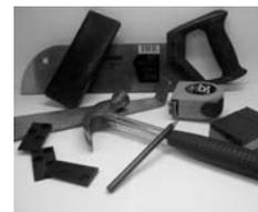
Pour scier les carreaux, utilisez une scie à main à dents fines, une scie à découper ou scie à tronçonner.
